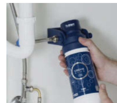
Montrér filterholderen til skabet og skru filteret i filterhovedet. Tilslut derefter filteret til koldt vandstilslutningen.
