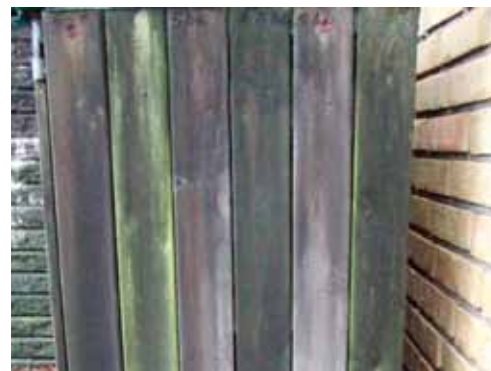
3. Praktisk forsøg med Boracol Special på brædder. Brædt 3 og 5 fra venstre er behandlet med Boracol Special og er fri for skimmel og alger. Brædt 2 og 6 er ubehandlede kontroller.
