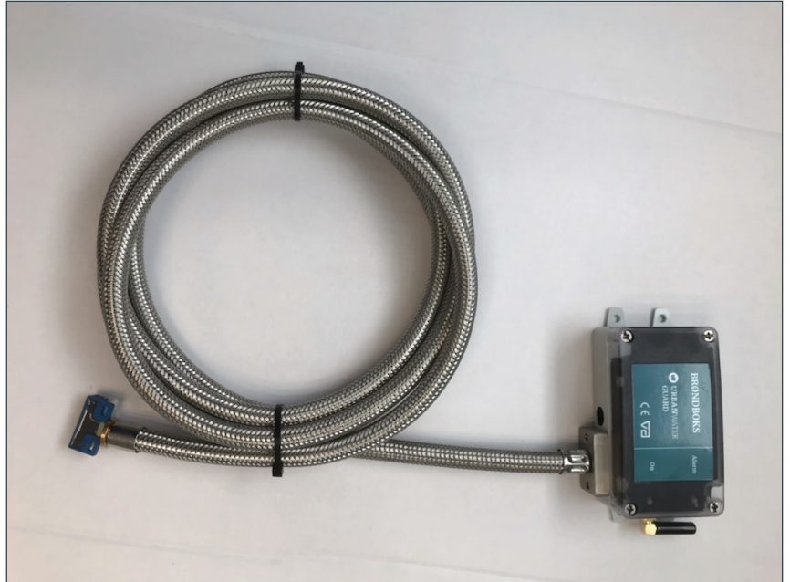
Figur 18 Brøndboks med sensor
